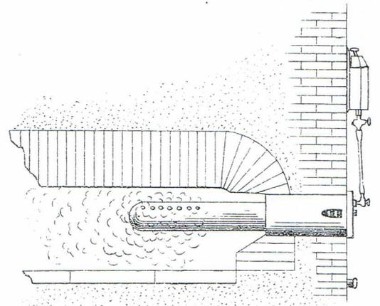
Disposition de l'appareil à buée et coupe d'un four.
